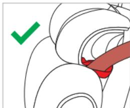
**!** **WARNUNG!** Der Diagonalgurt muss schräg nach hinten verlaufen und darf nie nach vorn zum oberen Gurtpunkt in Ihrem Fahrzeug führen. Sollte dies nicht einzustellen sein z.B. durch Verschieben des Autositzes oder Verwendung auf einem anderen Sitzplatz, so ist der Kindersitz für dieses Fahrzeug nicht geeignet.
