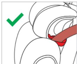
**!** **ATTENTION !** La ceinture diagonale doit passer inclinée vers l'arrière et ne doit jamais passer inclinée vers l'avant au point d'ancrage supérieur de la ceinture dans votre véhicule. S'il est impossible de régler le siège de cette manière, par ex. en poussant le siège auto pour enfant vers l'avant ou en l'utilisant sur un autre siège, ce siège auto pour enfant ne convient pas à votre véhicule.
